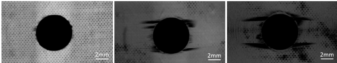
Abbildung 6: CT-Overlay-Bilder [1] von drei mit unterschiedlichen Bohrer-Verschleißgraden hergestellten Bohrungen. Die dazugehörige US-C-Bilder sind aus der Abbildung 5 zu entnehmen.
